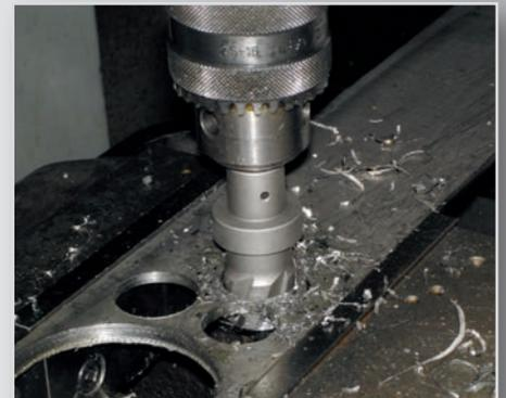
Bohren in Flachstahl
