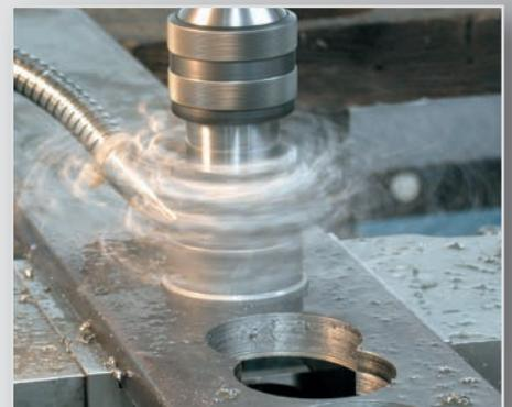
Bohren in Flachstahl
